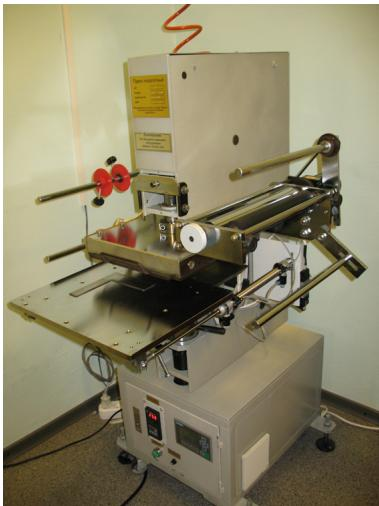
WT3-19 Пресс горячего тиснения с пневматическим приводом. Используется для различных видов тиснения: блинтового, конгревного, а также для малоразмерной вырубки. Обладает такими регулируемыми параметрами, как время прижима и автоматическая протяжка фольги, температура нагрева, скорость движения плиты. Выдвижной стол с упором для заготовок.
